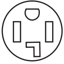
Tomacorriente de 4 hilos (14-30R)
