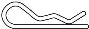
Chavetas de seguridad (2) (ubicadas en la bolsa que está dentro del tambor)
